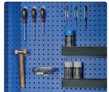
Gelochte Innenwände zur übersichtlichen Aufnahme von Werkzeugen und Lagergut mittels Lochwandhaken und Ablageböden.
